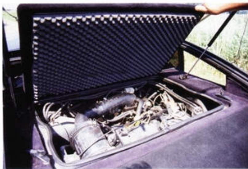
2,2 liter met 118 pk. Let ook op de isolatiematten om nog enig geluidscomfort te hebben
