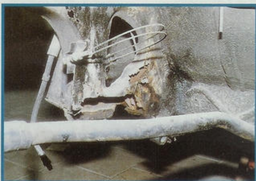
Vooraf de bevestigingspunten van de stabilisatorstang aan het chassis vragen extra aandacht: in dit geval zijn ze verdwenen!
