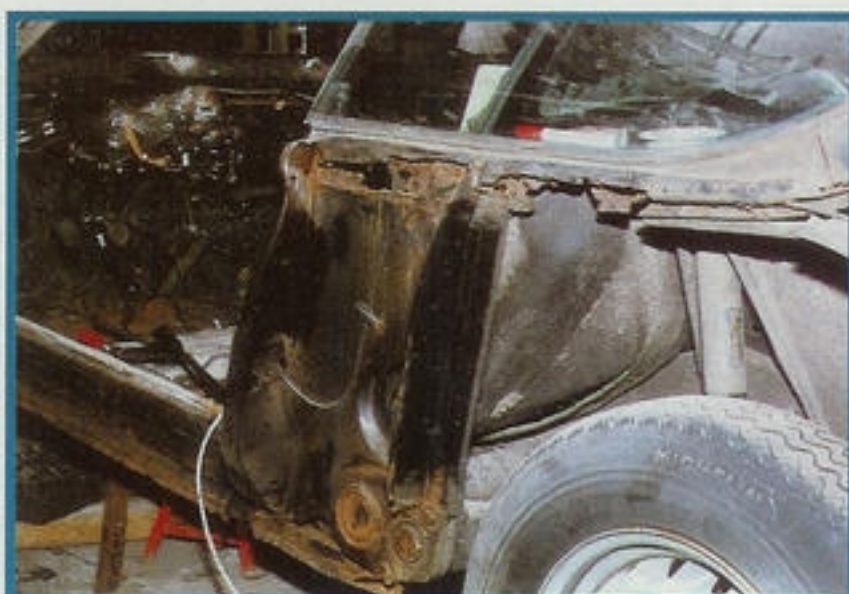
Het roestduiveltje en zijn helse praktijken. Hier (bij afgenomen carrosserie) onder de achterste zijruit. Goed zichtbaar is ook de bevestigingsbalk van de wieldraagarm
