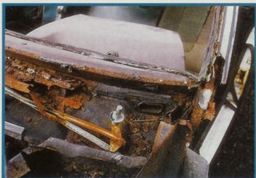
De onderplaat van de voorruit, waaraan het ruitwissersmechanisme is bevestigd, is hier geheel verdwenen
