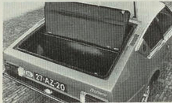
Kleine bergruimte onder achterklep.
